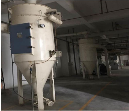
整改后粉碎工序脉冲布袋除尘器
