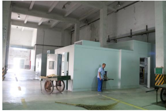
输送装置外加隔音层（隔声罩）
