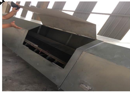
整改后筒仓原粮配料密闭投加
