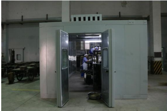
输送装置外加隔音层（隔声罩）
